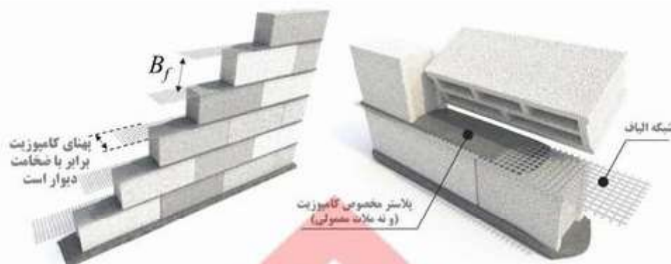
شکل ۳-۳ کمیت‌های مورد نیاز برای محاسبه ظرفیت خمش افقی دیوارهای بنایی مسلح به کامپوزیت شبکه الیاف در بند بستر.
