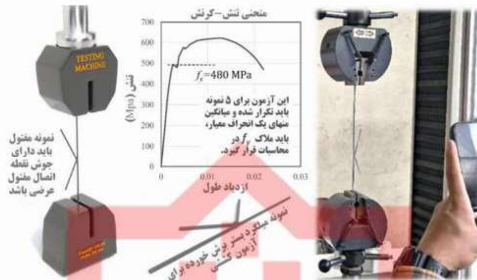
شکل پ-۴-۱ نحوه انجام آزمون کششی بر روی نمونه میگرد بستر.
