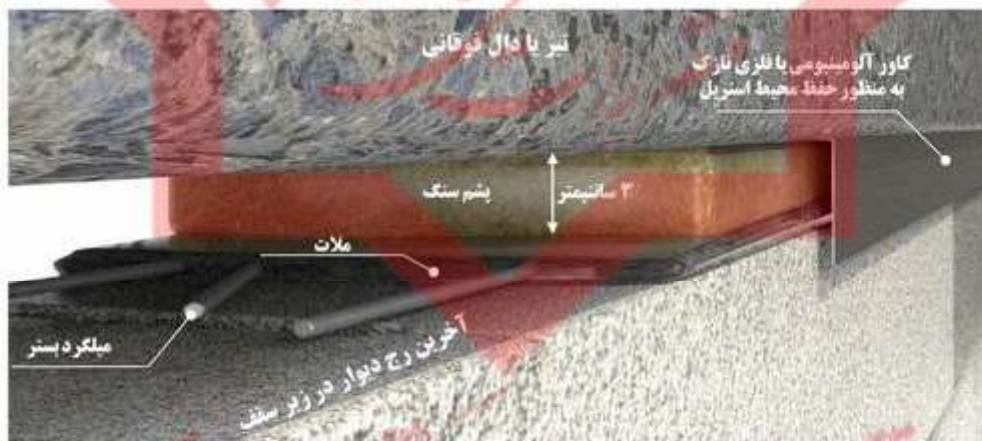
شکل پ-۵-۱۷ اجرای ملات و میلگرد بستر در آخرین رج دیوار در زیر سقف - اجرای میلگرد بستر در آخرین رج الزامی نبوده اما قابل توصیه است.
